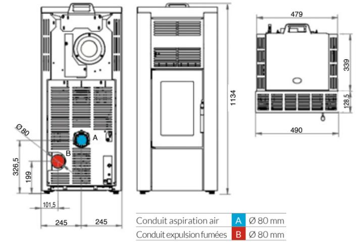
Conduit aspiration air **A** Ø 80 mm
