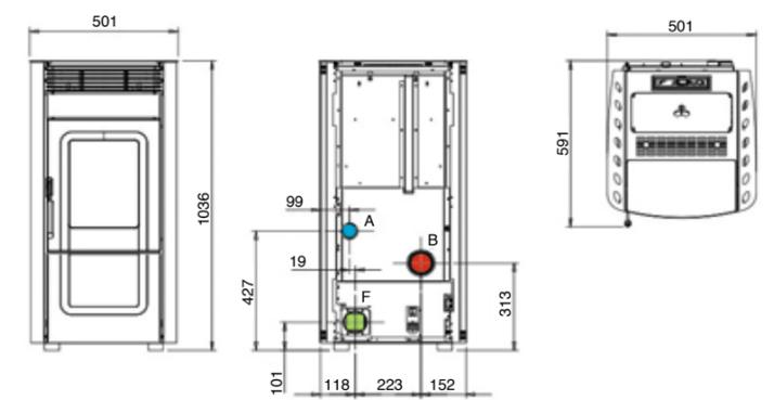
Conduit aspiration air **A** Ø 50 mm
