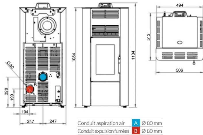
Conduit aspiration air **A** Ø 80 mm
