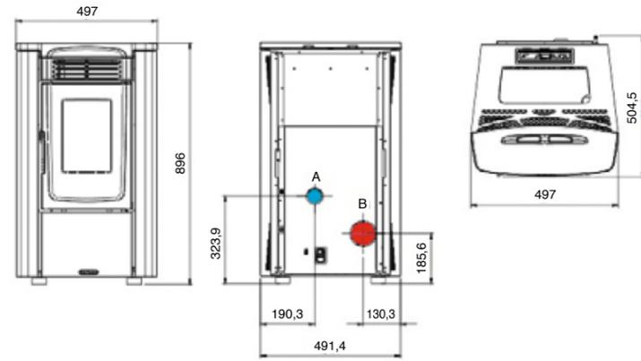
Conduit aspiration air **A** Ø 50 mm
